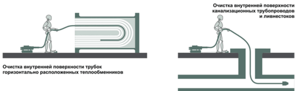
Рисунок 4 - Схема очистки трубок теплообменников
